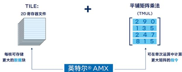
英特尔® AMX 架构由两部分组件构成：
